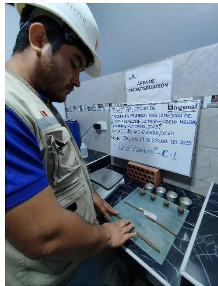
**Figura 11.** Ensayo del L.P, C-01.
