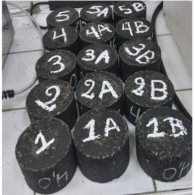
Figura 52. Preparación para la colocación a la maquina Marshall.
