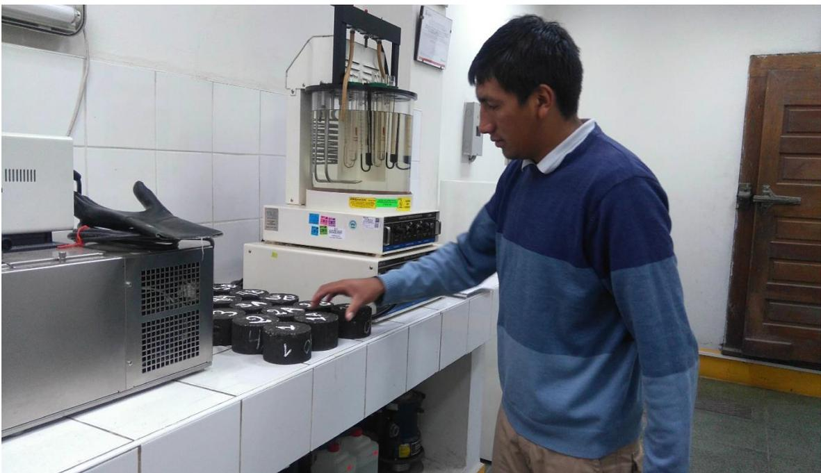
Figura 53. Briqueta después del ensayo Marshall.
