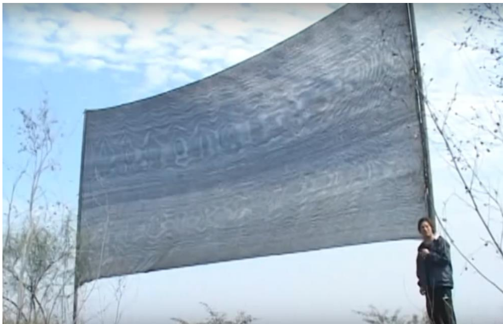
Figura N°11: Atrapanieblas instalado en las colinas de Edén de Manantial, Villa María del Triunfo
