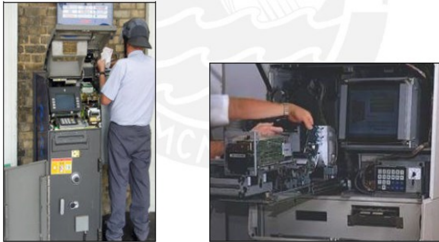
Figura 6. Interior de cajeros NCR durante el servicio de reabastecimiento. Fuente: Vásquez (2006).
