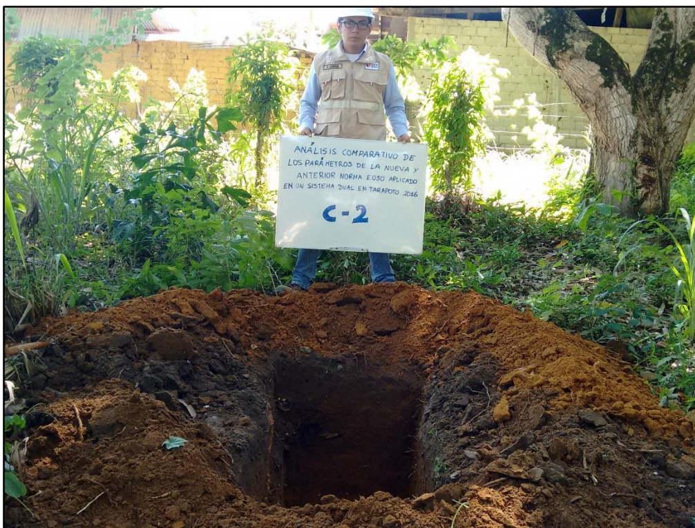
Foto 5: Extracción de muestras de la calicata N° 2
