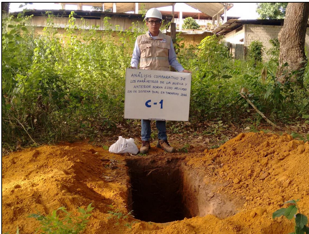
Foto 4: Extracción de muestras de la calicata N° 1
