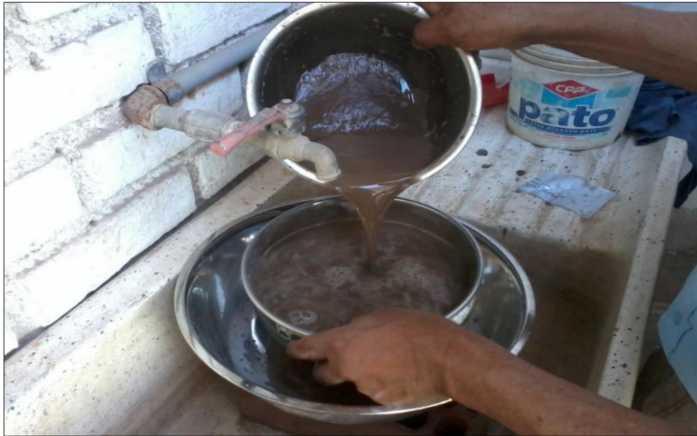
FOTO Nº 05 LAVADO DE MATERIAL PARA REALIZAR LA GRANULOMETRIA
