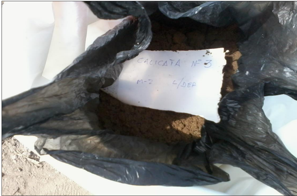
FOTO N° 03 ESTRATO DE MATERIAL PARA SER ANALIZADO EN LABORATORIO
