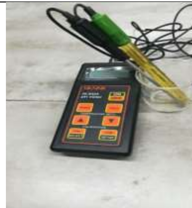
equipo para realizar las mediciones de pH de cada muestra de suelo.
