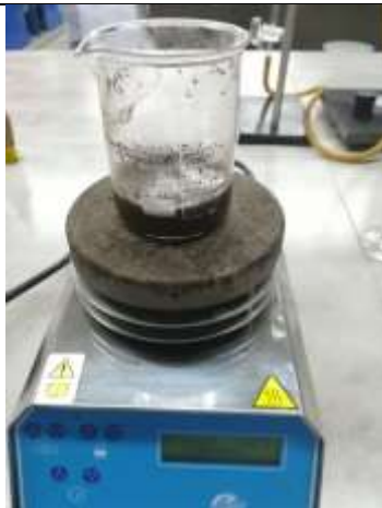
Agitador magnético 500 RPM por un tiempo de 15 minutos.
