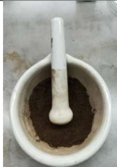
Proceso en la trituración de cada muestra de suelo en un mortero más pilón
