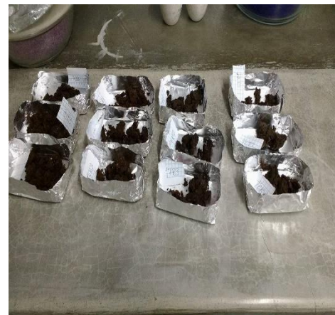
Muestras de humus ya terminada la determinación de humedad.
