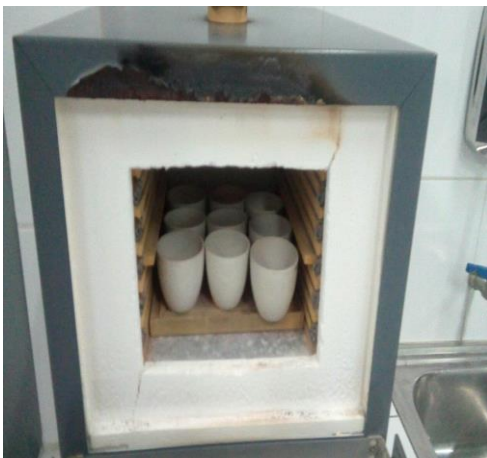
Muestras colocadas en la Mufila a 550° grados.
