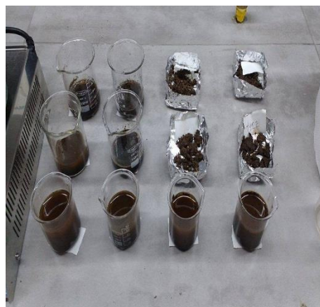
Muestras en el vaso precipitado de 100 ml. diluidas en agua destilada.
