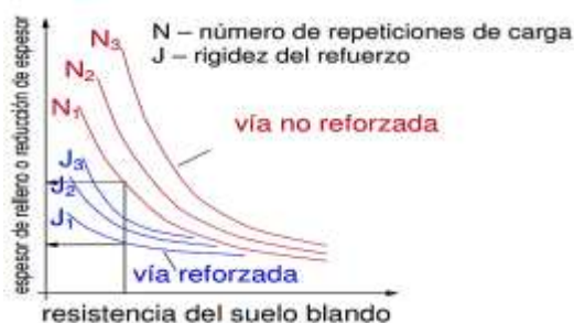
Fig. 1. 12. (Izq) Gráfico típico para diseño, (Der) Construcción de una vía no pavimentada reforzada sobre arcilla orgánica blanda.
