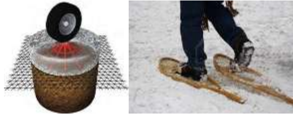
Fig. 3. 13. Mejoramiento de capacidad portante
