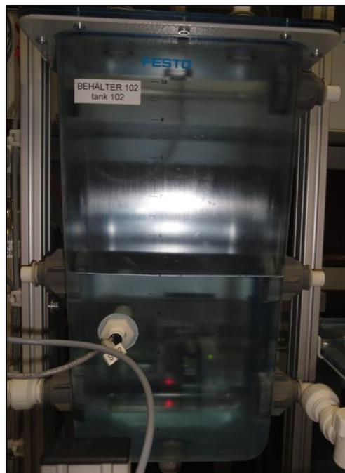
Figura N° 32. Nivel de líquido alcanzó el valor de la referencia
