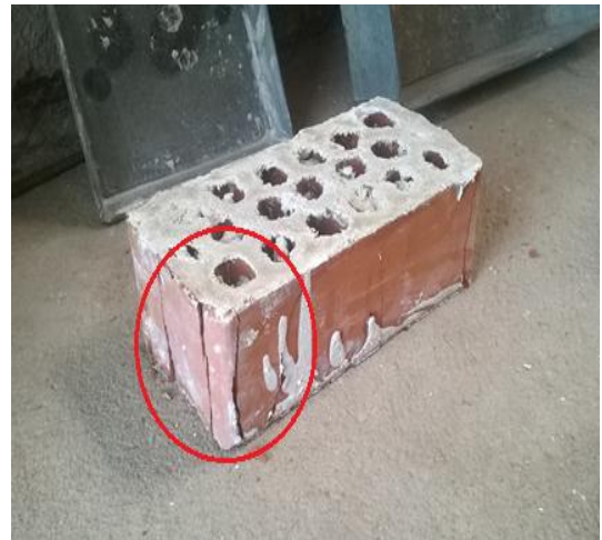
Figura 47. Fallas de las unidades de albañilería industrial y artesanal.
