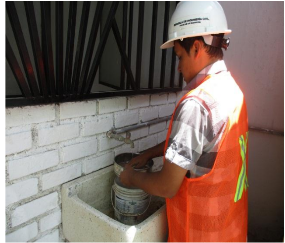
Figura 43. Análisis granulométrico por tamizado y lavado de la muestra de suelo.
