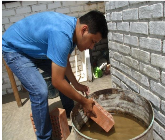
Figura 50. Unidades de albañilería sumergidas en agua fría 24 horas.
