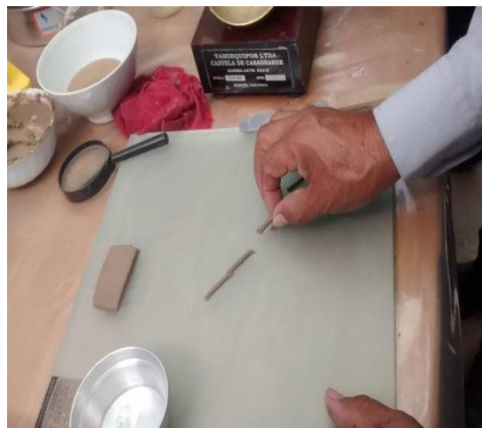
Figura 29. Ensayo de límite plástico.
