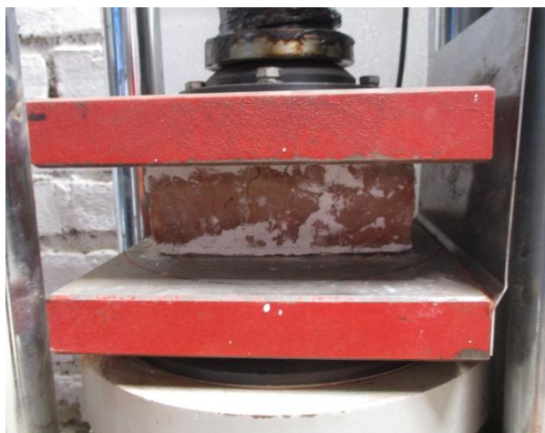
Figura 32. Ensayo de resistencia a la compresión.
