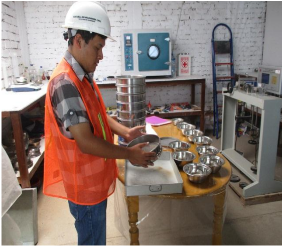
Figura 43. Análisis granulométrico por tamizado y lavado de la muestra de suelo.
