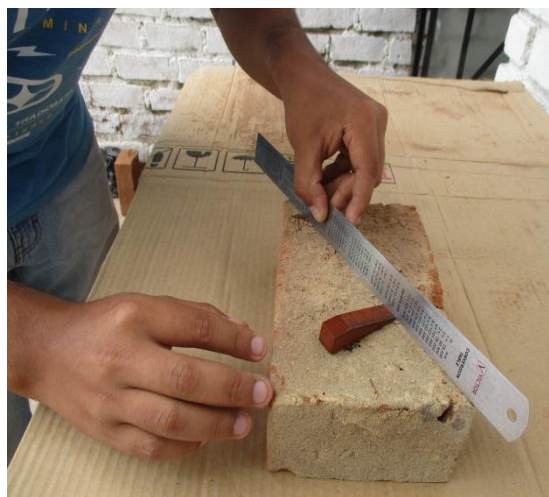
Figura 31. Medida del alabeo de la unidad de albañilería.
