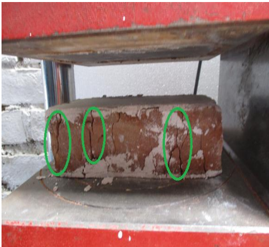
Figura 47. Fallas de las unidades de albañilería industrial y artesanal.
