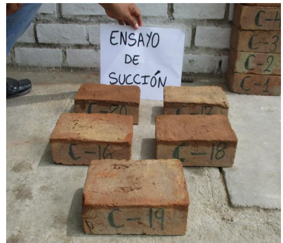
Figura 48. Evaluación de succión en las unidades de albañilería artesanal.
