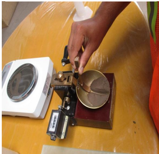
Figura 28. Ensayo de límite líquido.
