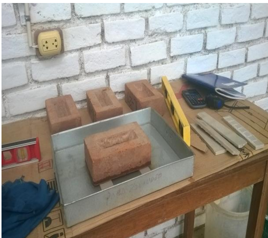
Figura 48. Evaluación de succión en las unidades de albañilería artesanal.
