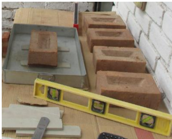
Figura 33. Ensayo de succión en la unidad de albañilería.
