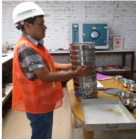
Figura 27. Análisis granulométrico por tamizado.
