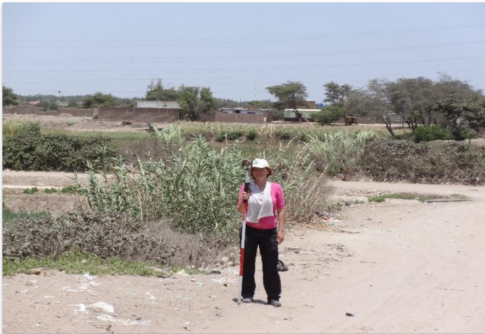
EN LA VISTA SE APRECIA TESISTA CON EL PRISMA EN EL LEVANTAMIENTO TOPOGRÁFICO
