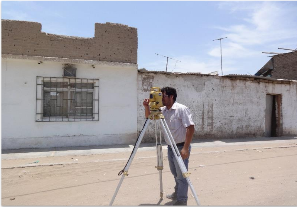
EN LA VISTA SE APRECIA TESISTA CON ESTACION TOTAL EN EL LEVANTAMIENTO TOPOGRÁFICO
