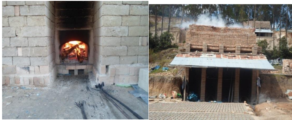
Figura 1.15. Quemado del ladrillo en un horno artesanal
