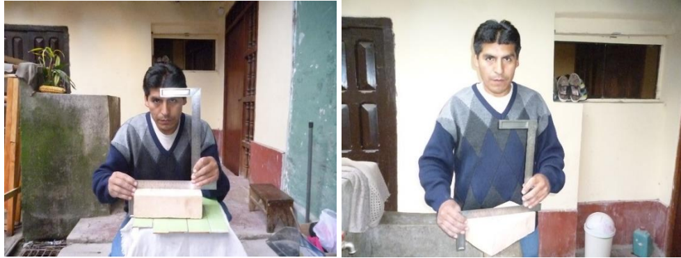
Fig. 3.2. Medición del alabeo
