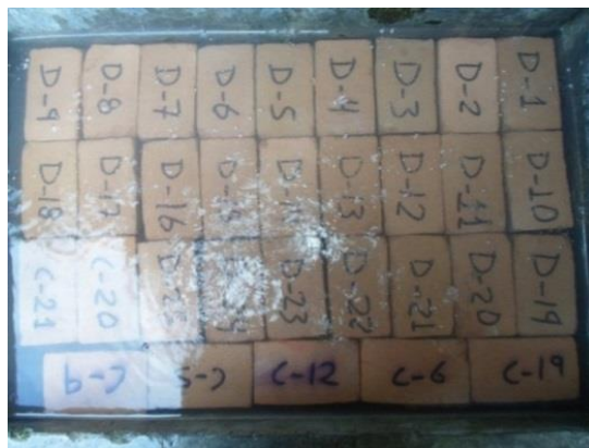
Fig. 1.7. Absorción del ladrillo
