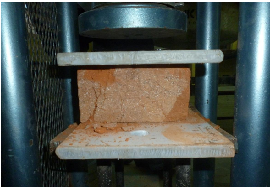
ESPECIMEN DESPUES DE RECIBIR LA CARGA ALABEO
