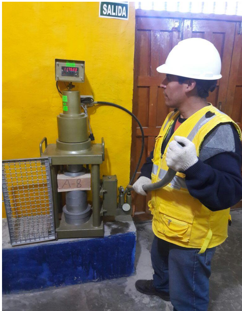
ESPECIMEN DESPUES DE RECIBIR LA CARGA ALABEO
