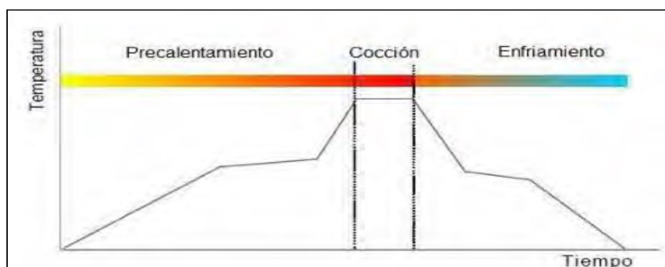
Figura 1.18. Ciclo de cocción típico de un producto de arcilla (Terán 2013) En la etapa de enfriamiento la temperatura desciende desde la de cocción hasta la normal, esto debe realizarse paulatinamente (de 500°C a 600°C), especialmente en los hornos cerrados, para garantizar dureza, tenacidad y colorado de las piezas vitrificadas.
