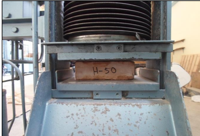
Fig. 1.4. Ensayo de resistencia a la compresión del ladrillo
