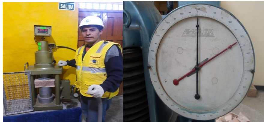
Fig. 3.4. Ensayo de compresión
