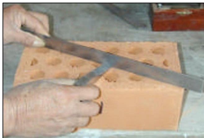
Fig. 1.6. Alabeo del ladrillo
