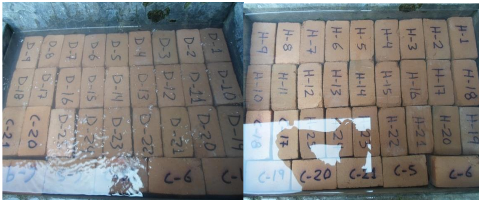
Fig. 3.5. Absorción en ladrillos de arcilla
