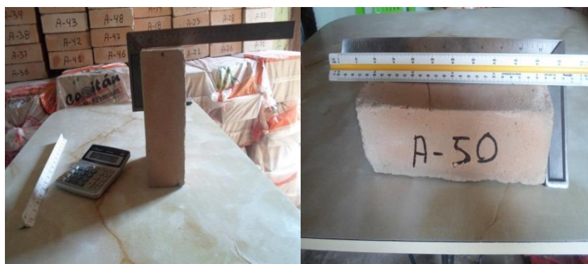
Fig. 3.1. Medición del largo, ancho y alto de los especímenes
