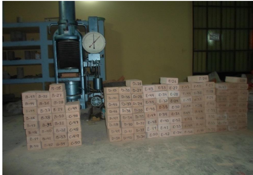
Fig. 3.3. Especímenes para el ensayo de compresión axial.
