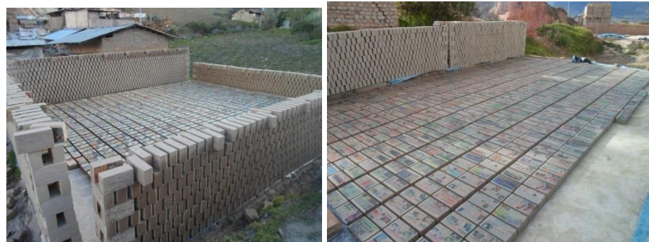
Figura 1.14. Secado del ladrillo artesanal al ambiente
