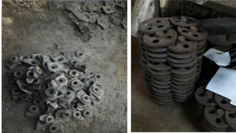
Vistas de Piezas Fundidas con Incrustaciones de Arena
