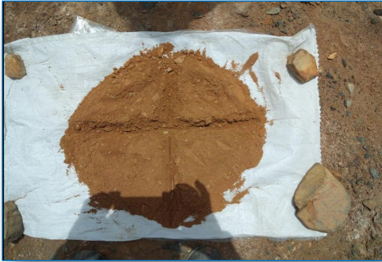
Figura 6. Método de cuarteo de muestras
