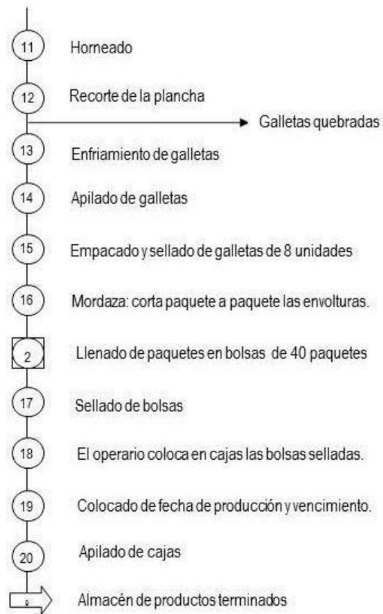
**Figura 16:** Diagrama de operaciones del proceso de galletas – Segunda parte
