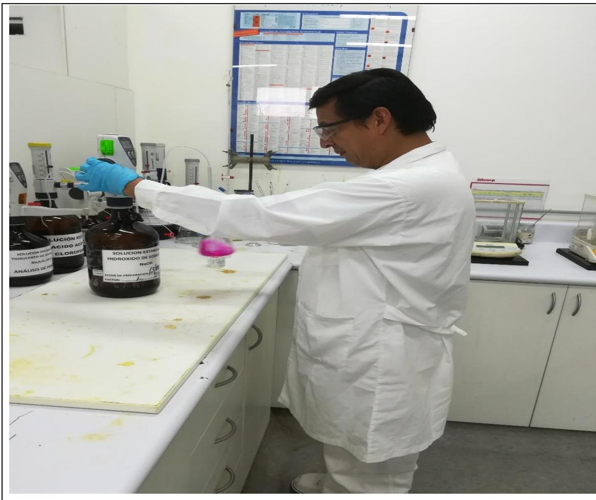
FIGURA 22. Pruebas químicas determinación acidez y dióxido de azufre
