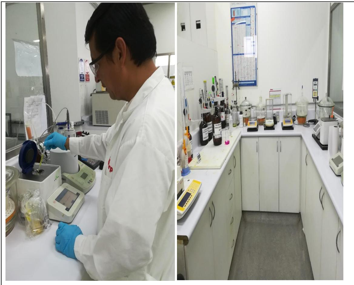
*FIGURA 19. Prueba grados Brix*
