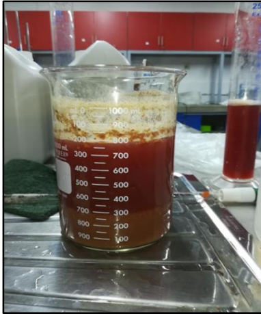
Foto 17: Sedimentación de los flocs
