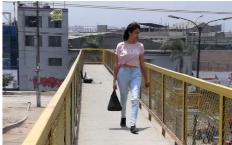
Figura 3. 26. Prueba de vibración forzada - 1 peatón.
