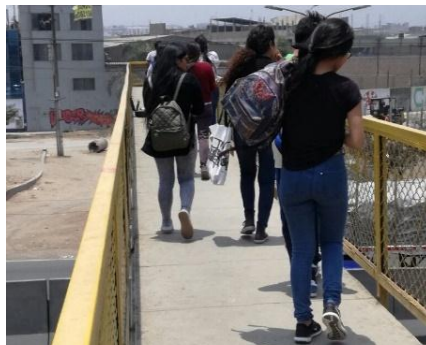
Figura 3. 27. Prueba de vibración forzada - 10 peatones
