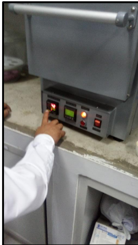
Figura 20: Carbonización del Bagazo a 400 °C.
