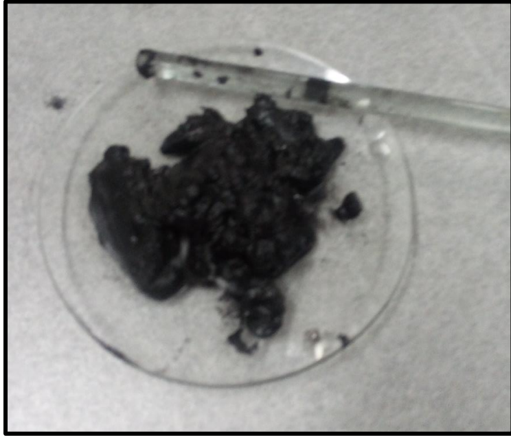
Figura 25: Secado del Bagazo durante 24 Horas a 50 °C.
