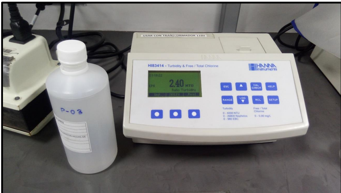
Figura 34: Medición de Turbidez.
