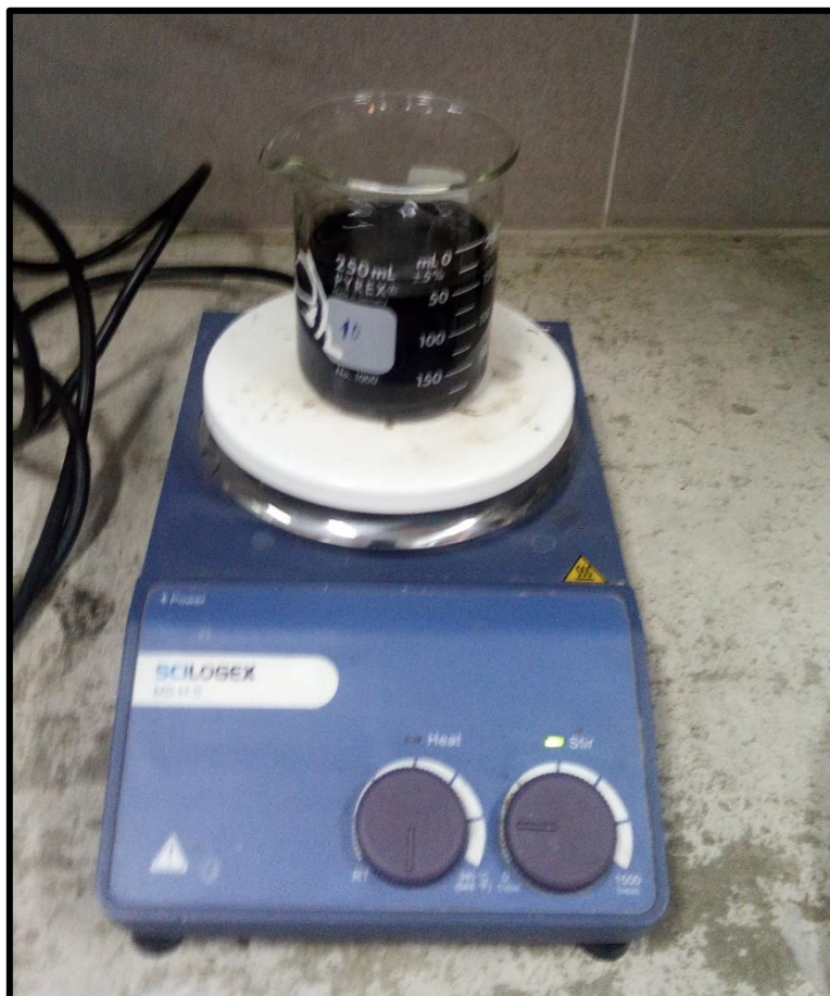
Figura 24: Impregnación de H_3PO_4 en el agitador durante 20 minutos.
