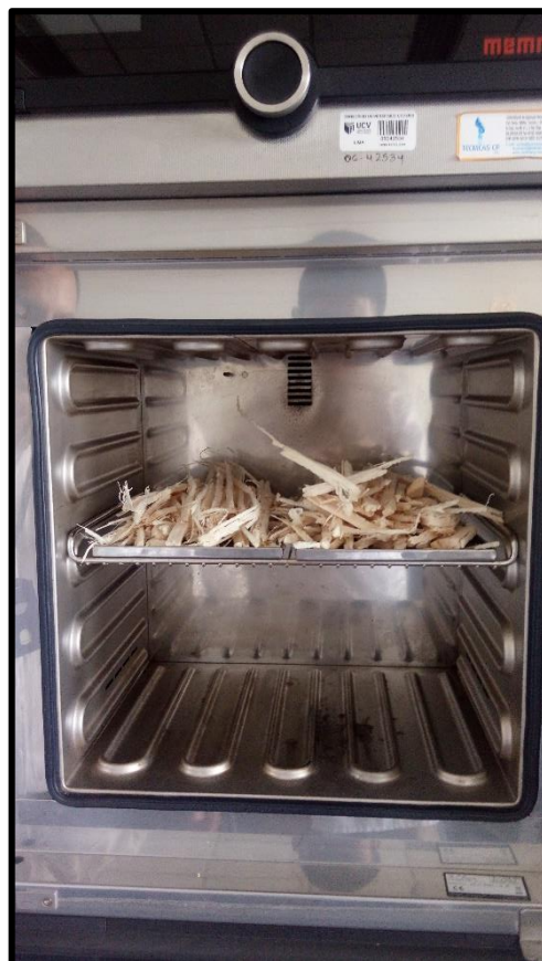
Figura 16: Secado en estufa a 105 °C durante 36 Horas.
