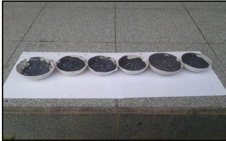
Figura 10. Semiconductores ( \text{ZnO-TiO}_2 ) rociados con plata (Ag)
