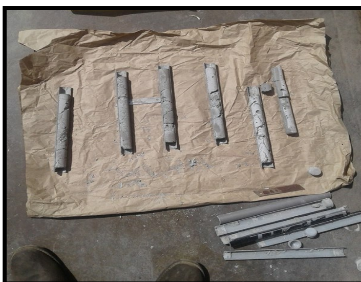
Figura 18. Composición Fotocatalítica sin plata (Ag) solidificado de forma cilíndrica
