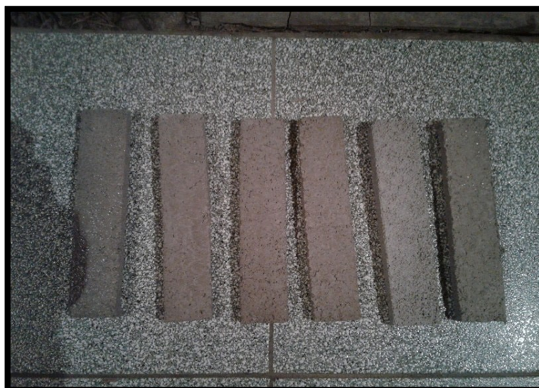
Figura 20. Composición Fotocatalítica sin plata (Ag) solidificado de forma rectangular.
