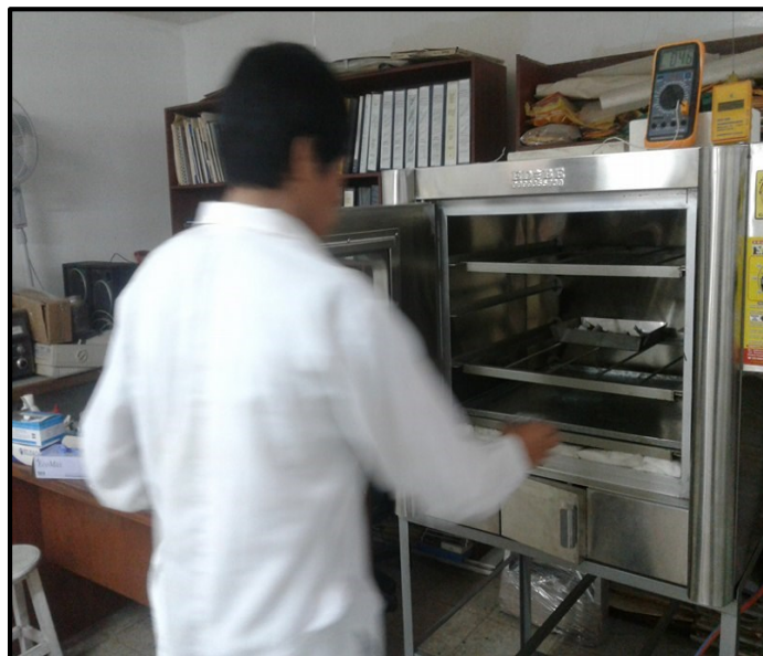
Figura 11. Calcinación de la mezcla homogénea de ( \text{TiO}_2 - \text{ZnO} , rociados con plata (Ag)
