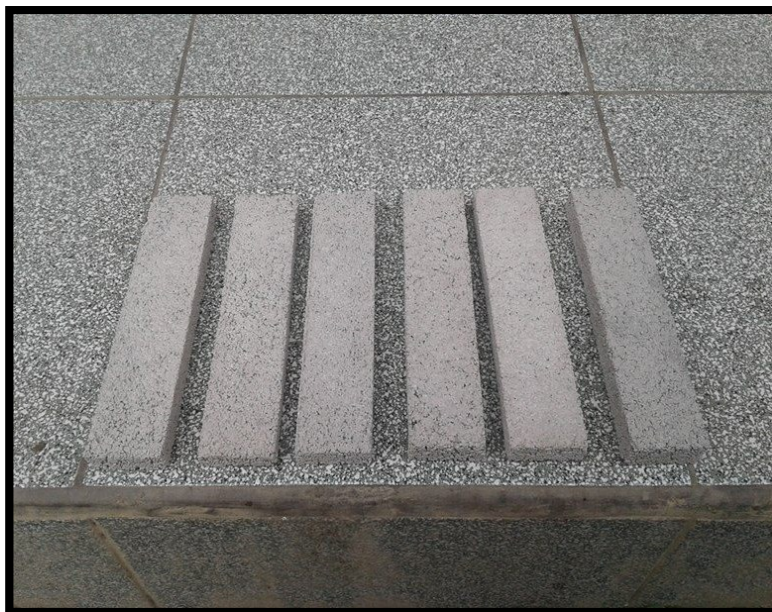
Figura 19. Composición Fotocatalítica sin plata (Ag) solidificado de forma rectangular
