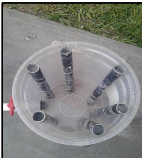
Figura 8. Compactación de la mezcla homogénea en moldes cilíndricos
