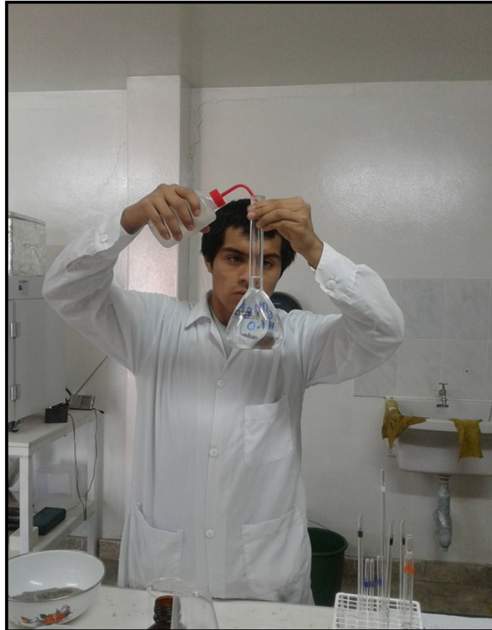
Figura 27. Preparación del Nitrato de plata a concentración de 0.1M
