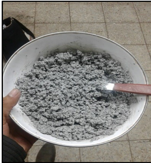
Figura 7. Homogenización de los semiconductores ( \text{ZnO-TiO}_2 ) con el Cemento portland y Cuarzo
