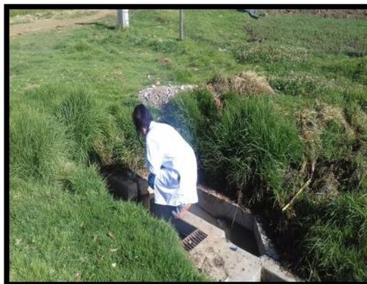
**Figura N° 25: Recojo de aguas residuales de la salida de la PTAR para su análisis**
