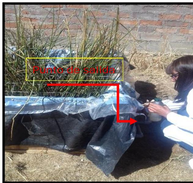
Figura N° 14: Salida de agua tratada por Humedal artificial
