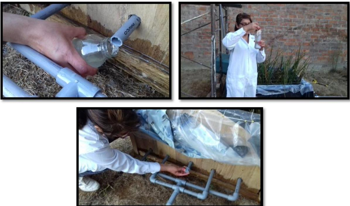
**Figura N° 33: Recojo de aguas residuales en el segundo mes de tratamiento**
