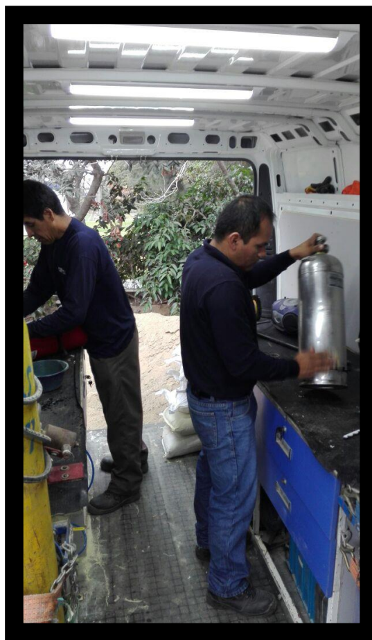
Figura 02: recarga de extintores
