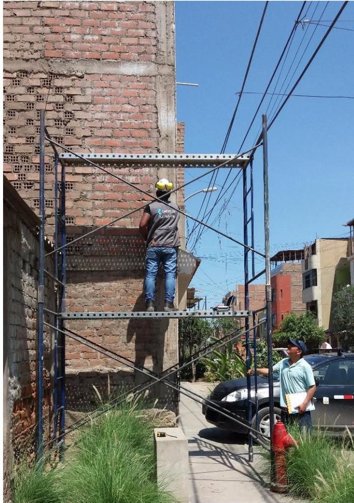
FIGURA 4: Ensayos realizados con el esclerómetro en campo
