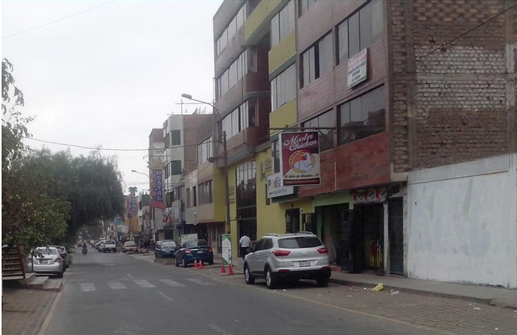
FIGURA 11: Viviendas con planta baja inusualmente alta
