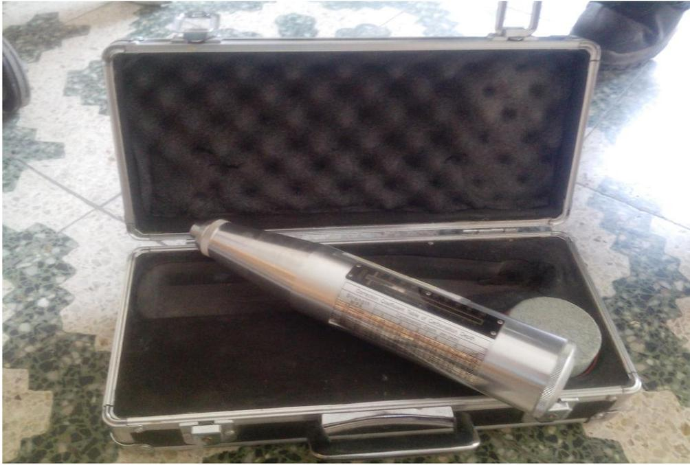
FIGURA 2: Esclerómetro Pinzuar de laboratorios Aricageos
