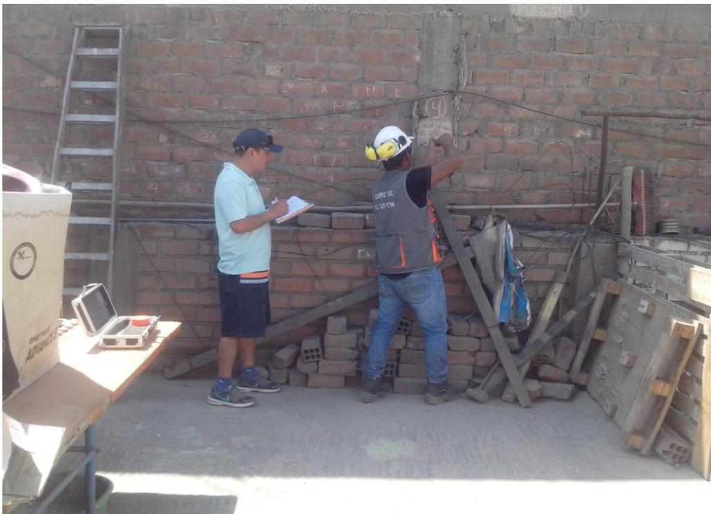
FIGURA 3: Ensayos realizados con el esclerómetro en campo
