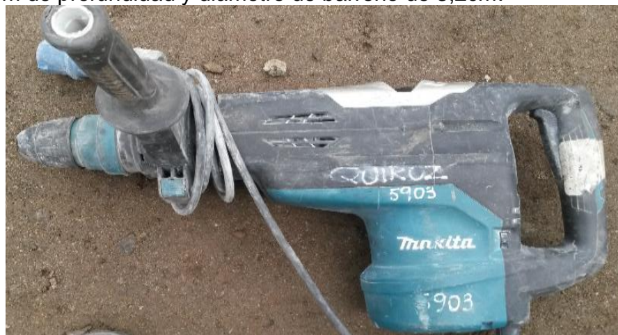
Figura 3.08: Taladro de 1,510 Watts de potencia Fuente: Elaboración propia.
