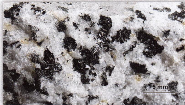
Foto 3.- Vista cercana de la vista anterior, mostrando mejor detalle de la textura fanerítica. En colores más claros: plagioclasas, ortosa y cuarzo. En tonos oscuros, biotita, hornblenda y magnetita.
