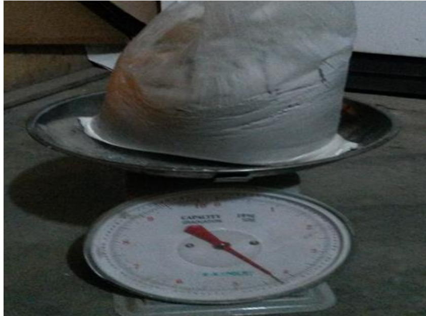
Figura 3.11: Pesado del cemento expansivo Fuente: Elaboración propia.
