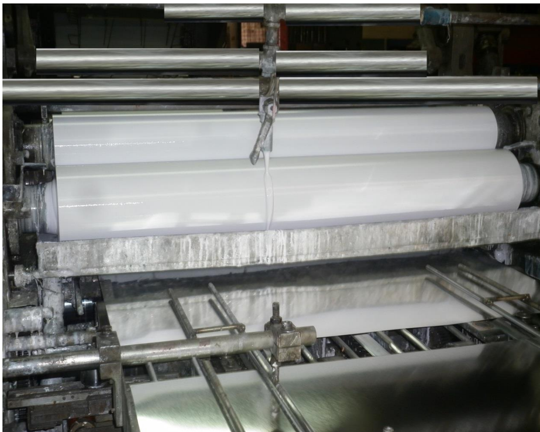
Foto 2. Aplicación del esmalte en las láminas.
