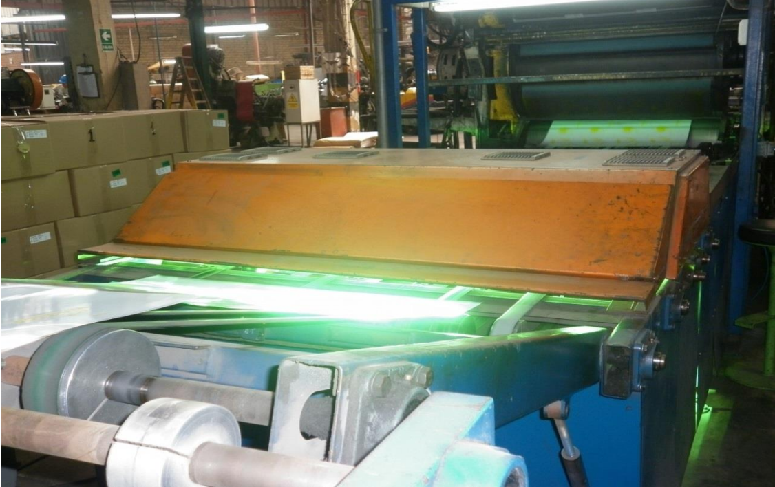
Foto 4. Ingreso de película húmeda al horno.
