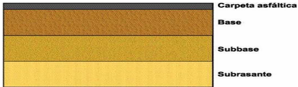
Ilustración 3: Estructura del Pavimento.
