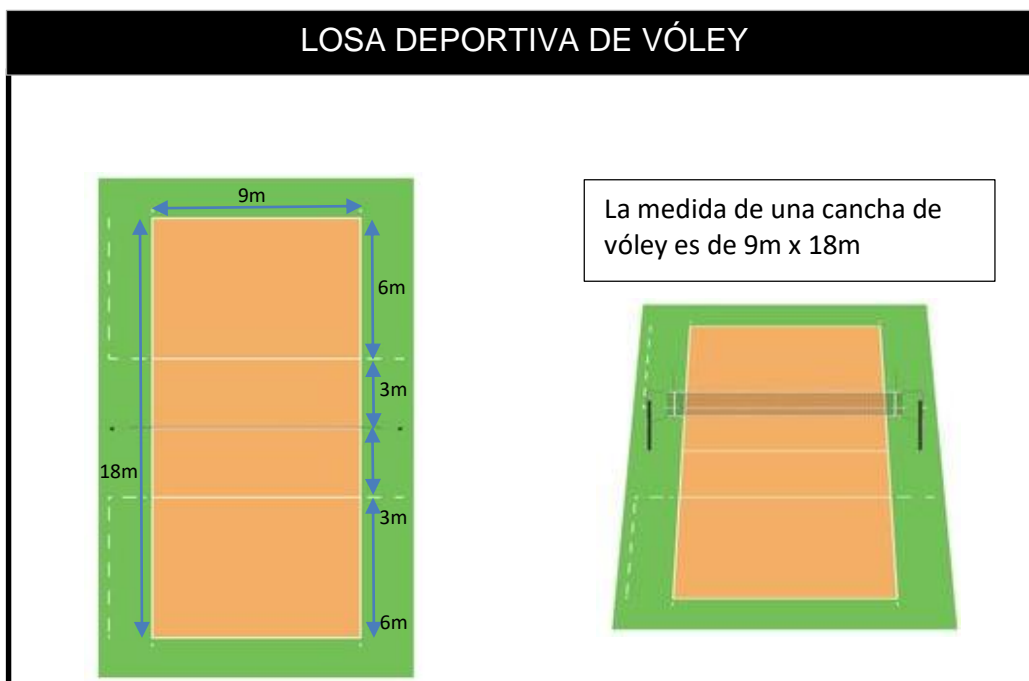
Figura 41: Medidas de losa deportiva de vóley
