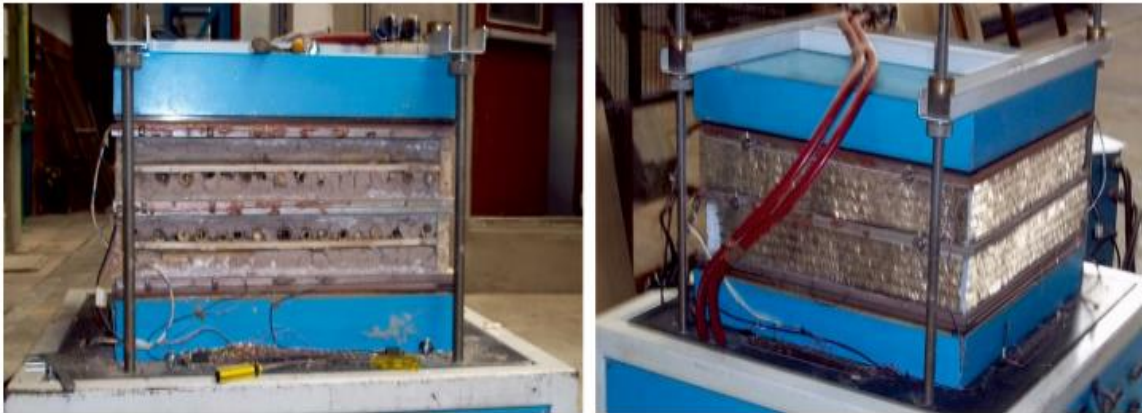
Figura 1.3. Ensayo de paneles de quincha en máquina de placa caliente
