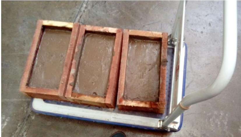
Figura.3.85. Moldes para ensayo de exudación
