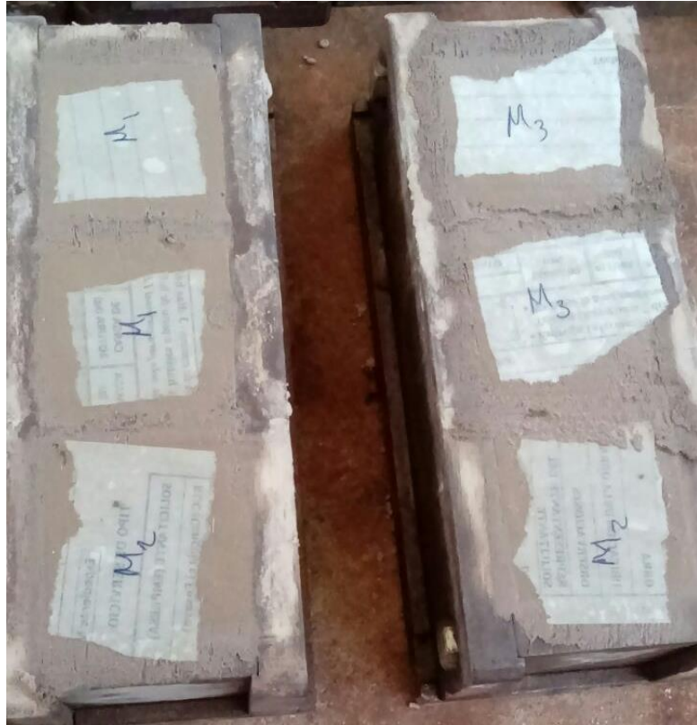
Figura 3.9. Muestras para compresión
