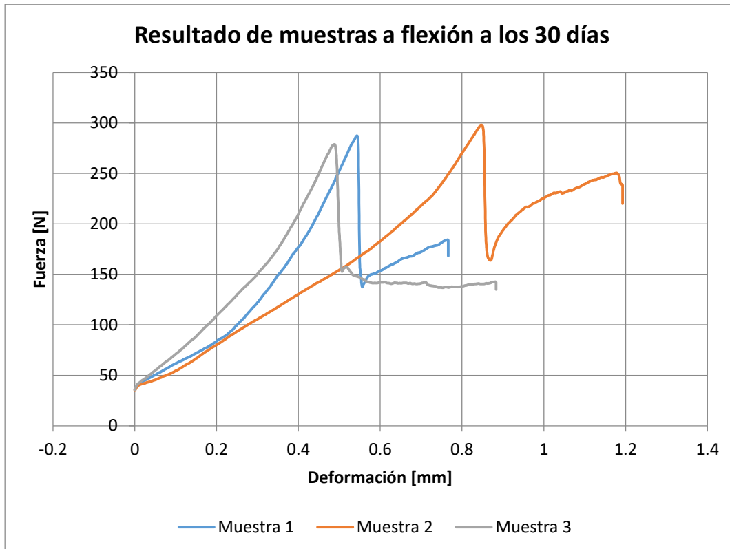
Figura 3.84. Resultado de muestras a flexión a los 30 días
