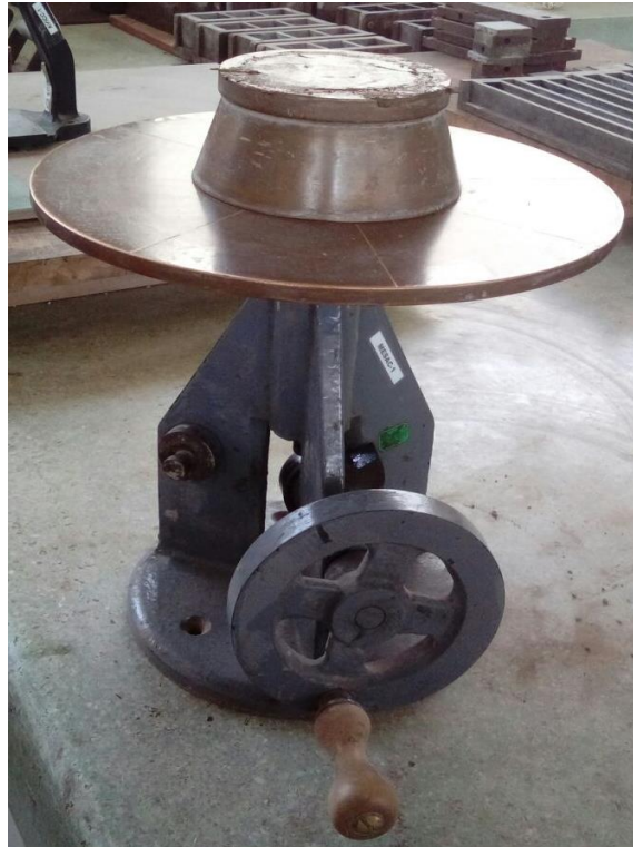
Figura 3.5. Máquina de fluidez
