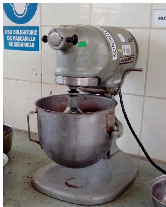
Figura 3.4. Mixer para dosificación de morteros
