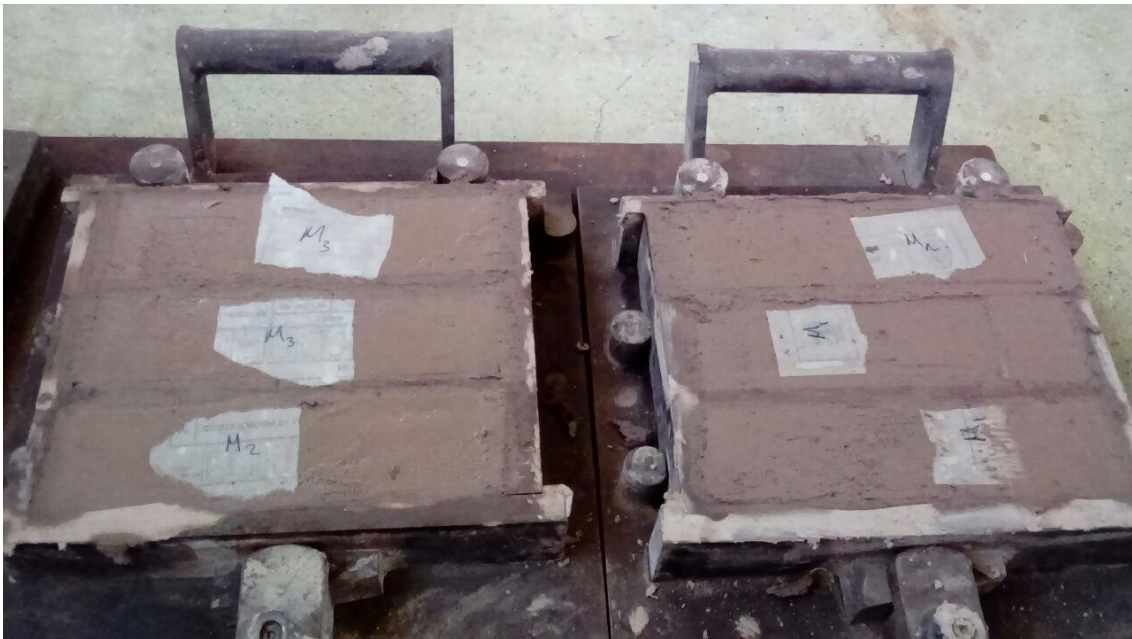
Figura 3.11. Moldes para ensayo de flexión
