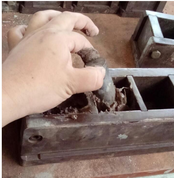
Figura 3.8. Moldes para ensayos de compresión de morteros
