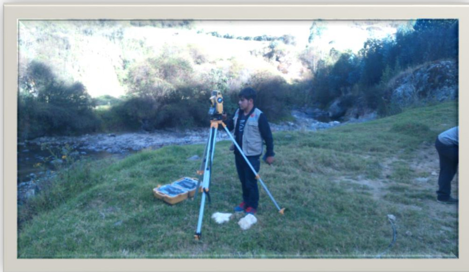
LEVANTAMIENTO TOPOGRÁFICO ENTRE LOS KMS 2 Y 5
