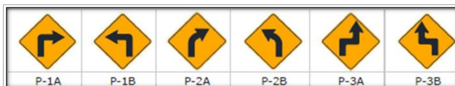
Figura 41: Señales preventivas en proyecto
