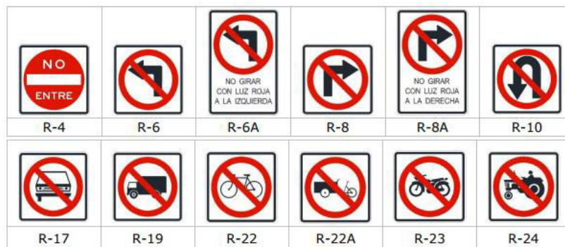
Figura N°79: Señales de prohibición
