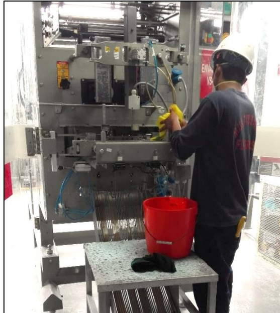
Figura 18. Limpieza de cabina interna en el primer piso.
