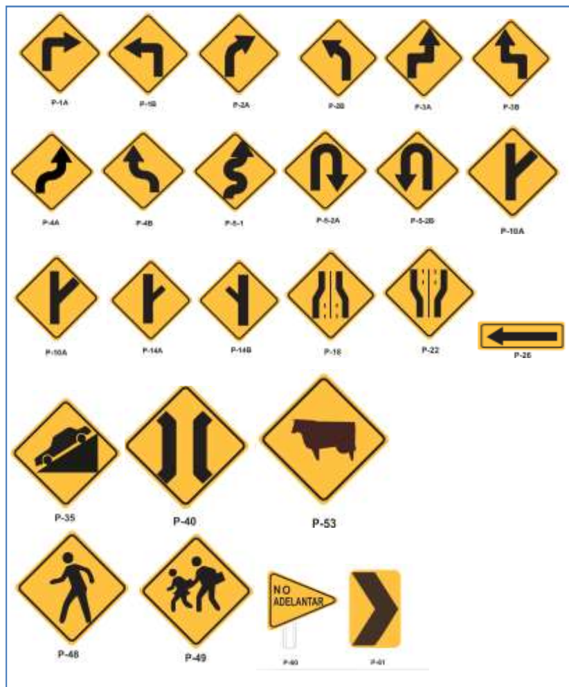
Ilustración 27. Simbología de las señales de cruce
