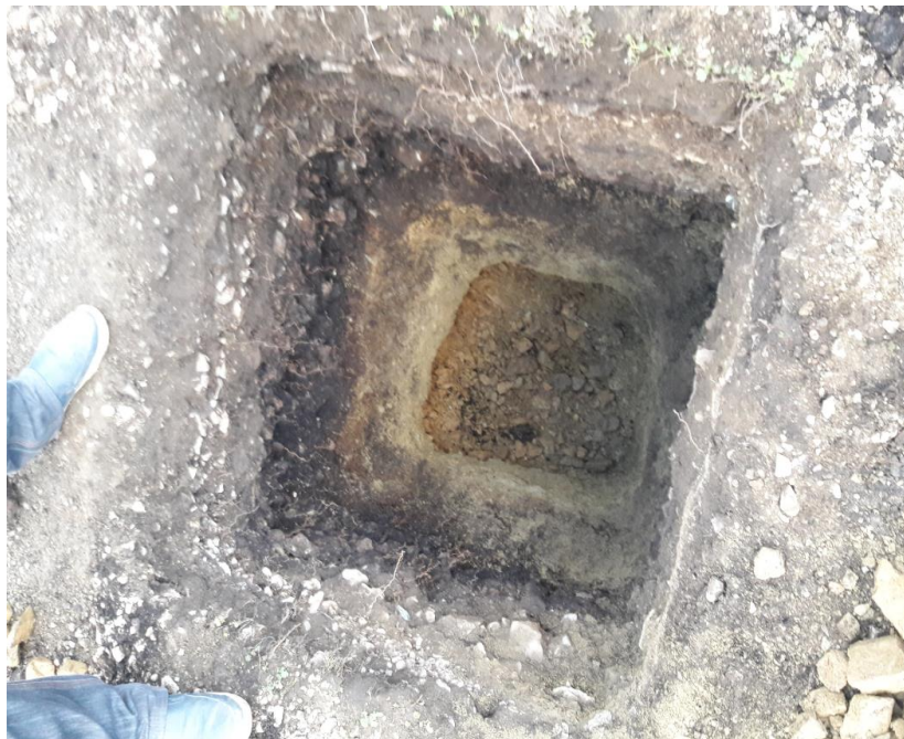
Fig. 10: La imagen muestra los diferentes estratos del terreno.
