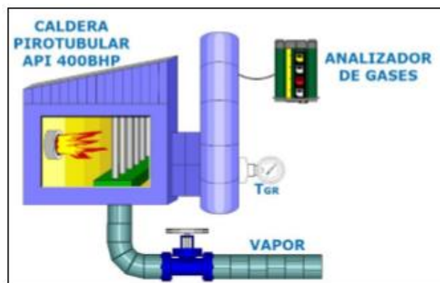
Figura 04: análisis de gases de chimenea al caldero pirotubular de 400 BHP. Fuente: Testo, Empresa Alicorp SAA, 2013.
