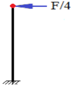
Figura 3.36. Esquema de la fuerza de trabajo sobre la columna
