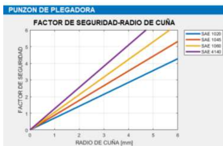
Figura 35. Radio de cuña – Factor de seguridad de punzón de plegado
