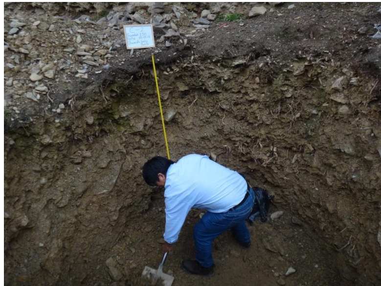
Figura III-6: Excavación de calicata de la primera caracterización. Fuente: Propio.
