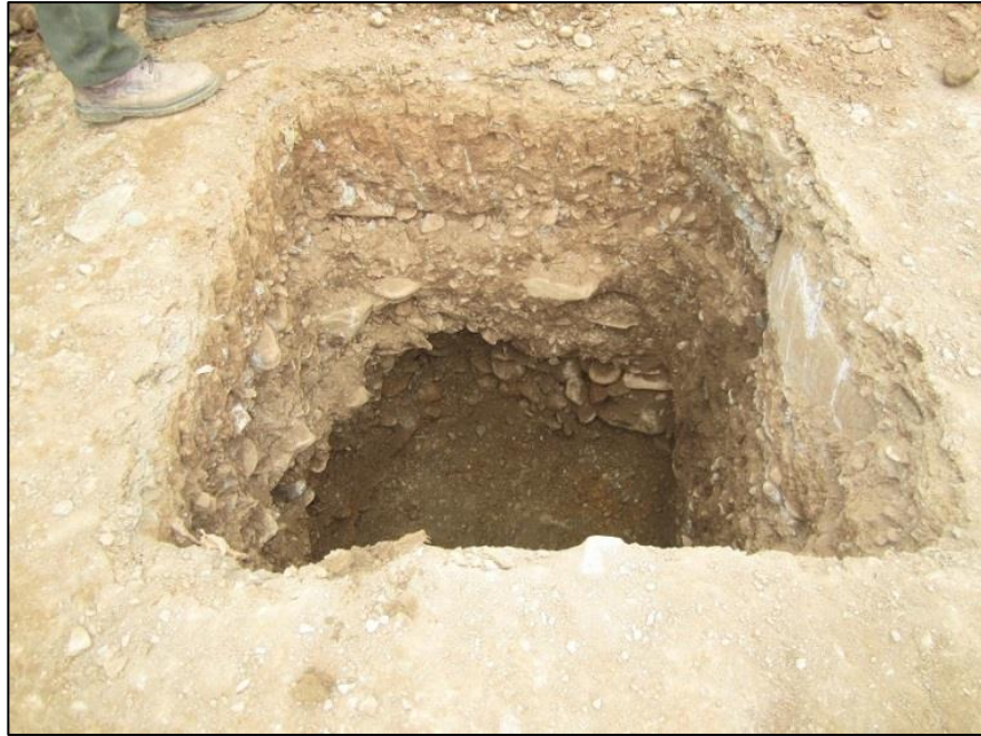
Figura III-4: Excavación de calicata de la primera caracterización. Fuente: Propio.
