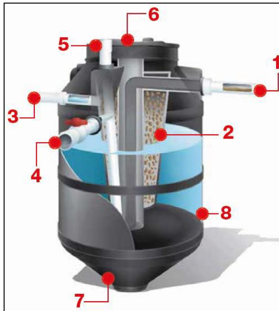
Figura I-2: Partes del funcionamiento de Biodigestor Nicoll. Fuente: Ficha técnica Nicoll (2016).
