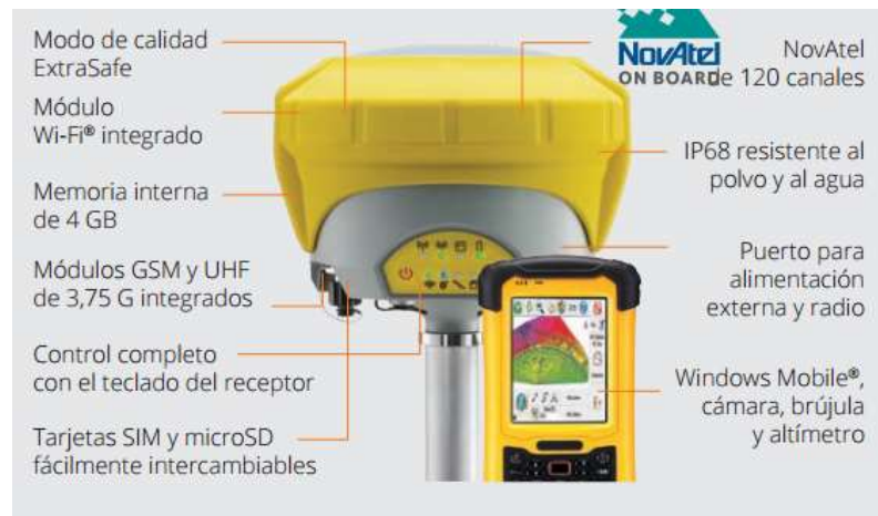
Figura I - 11 Partes del receptor GNSS.
