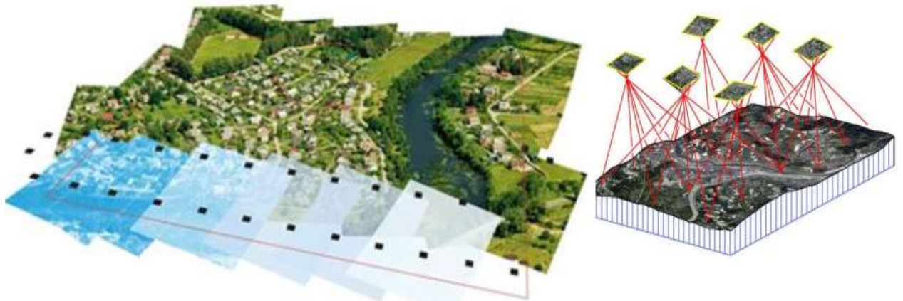
Fuente: http://www.mecinca.net Figura III - 9 Solapamiento de imágenes.
