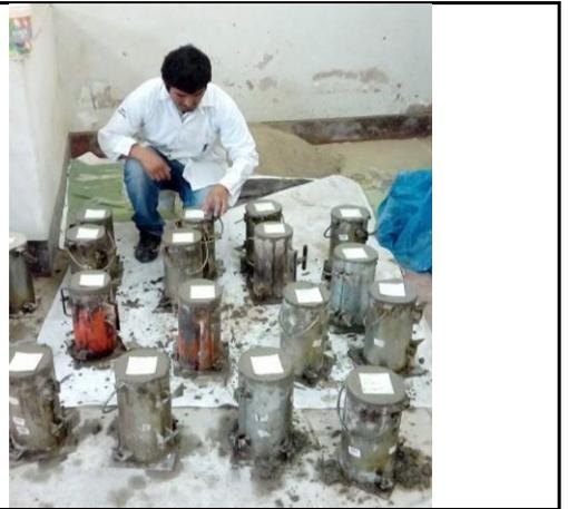
**PREPARACION DE TESTIGOS (PROBETAS)**
