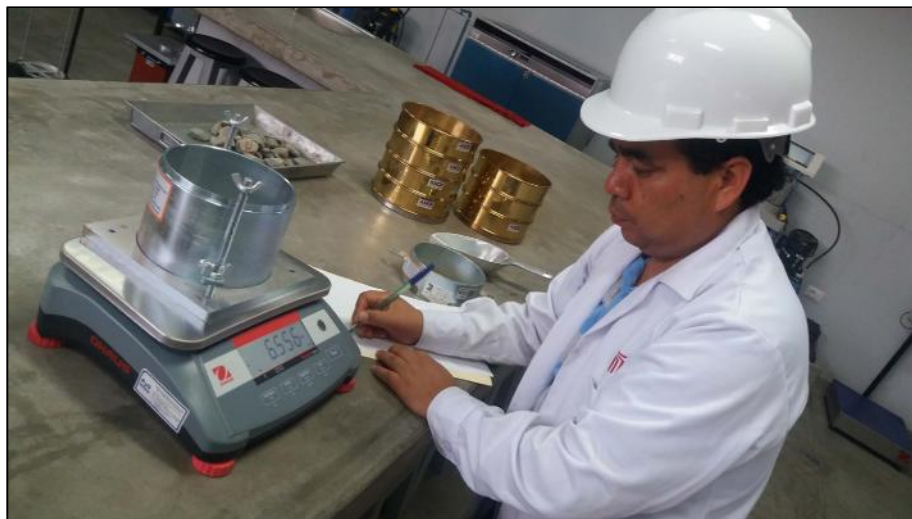
Figura 4. Tara del recipiente para la determinación de la relación densidad / humedad (Proctor) en el laboratorio de la Universidad Cesar Vallejo.
