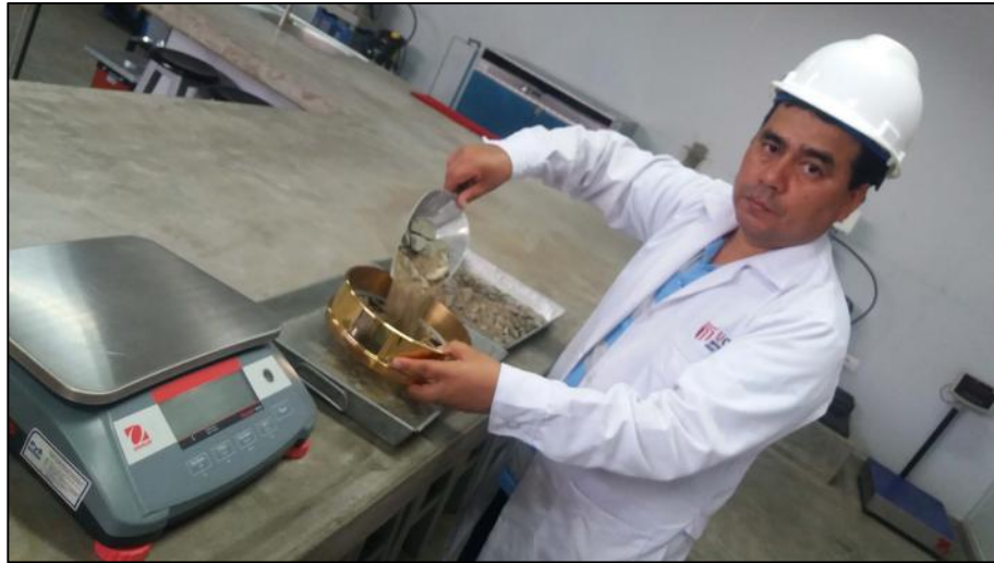
Figura 3. Tamizado de la muestra para el análisis granulométrico en el laboratorio de la Universidad Cesar Vallejo.
