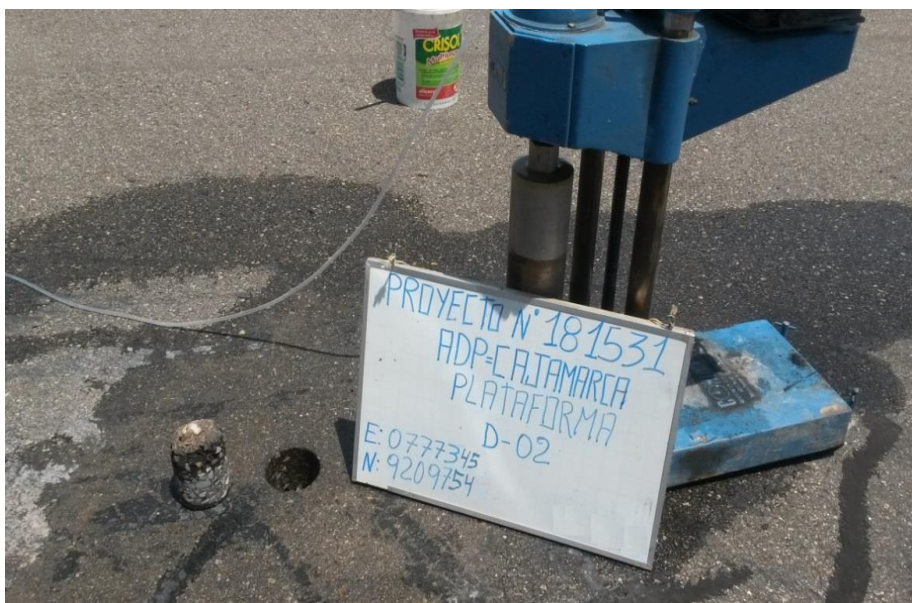
Figura 105. D-02.-Proceso de extracción de núcleo diamantino Fuente: EFE – 2015 - AdP
