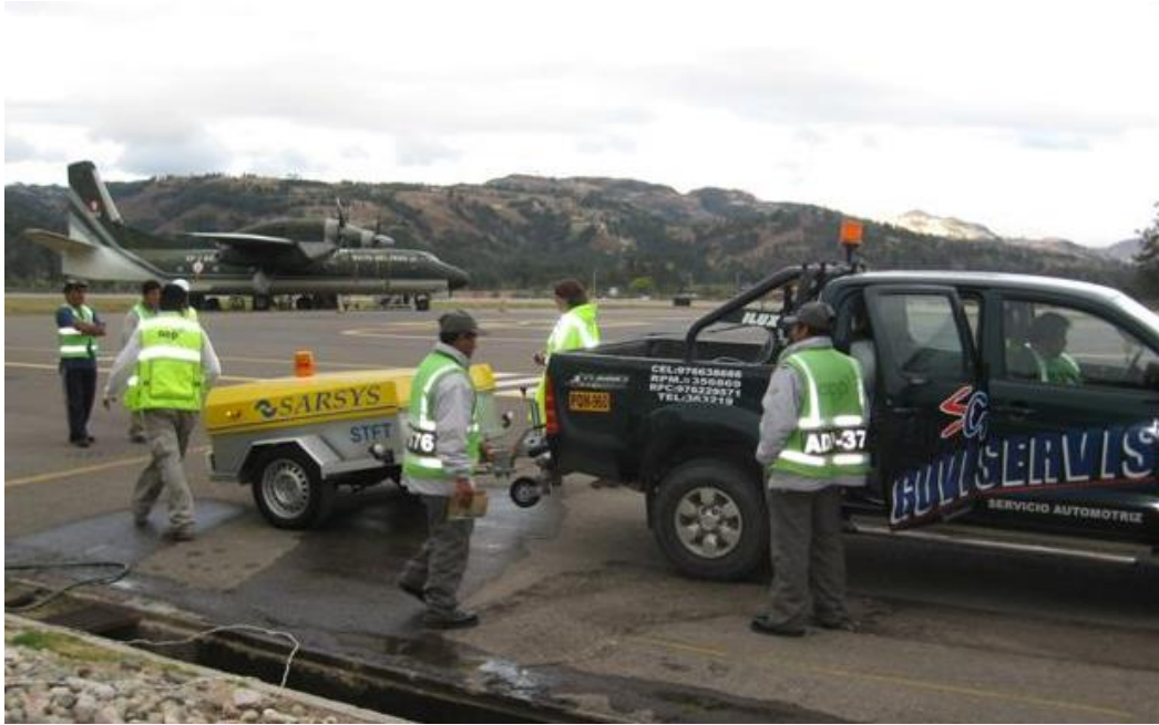
Figura 97. Medición de coeficiente de Fricción Fuente: Propia
