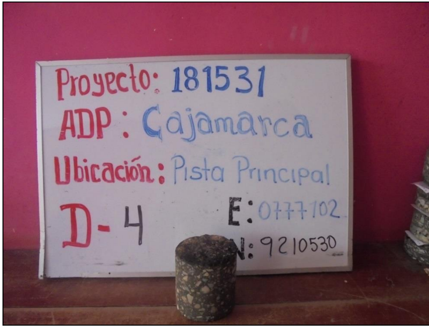
Figura 109. D-04.-Proceso de extracción de núcleo diamantino en la pista de aterrizaje Fuente: EFE – 2015 - AdP
