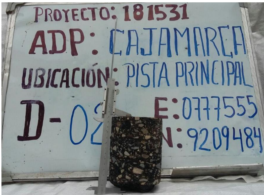
Figura 112. D-02.-Proceso de extracción de núcleo diamantino en la pista de aterrizaje Fuente: EFE – 2015 - AdP
