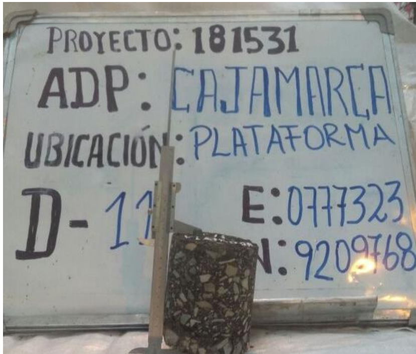
Figura 121. D-11.-Proceso de extracción de núcleo diamantino en la pista de aterrizaje Fuente: EFE – 2015 - AdP
