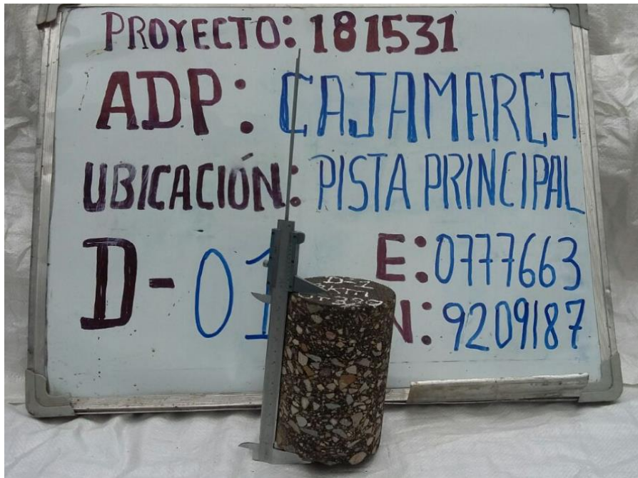
Figura 111. D-01.-Proceso de extracción de núcleo diamantino en la pista de aterrizaje Fuente: EFE – 2015 - AdP
