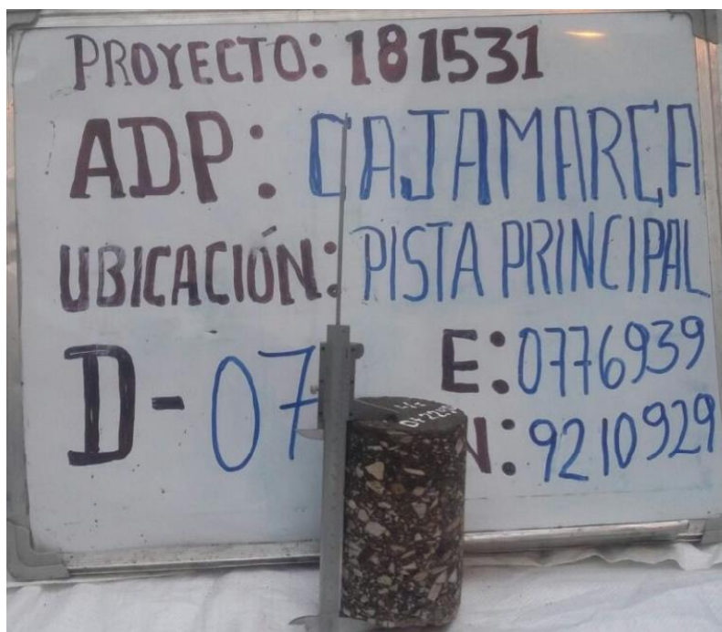
Figura 117. D-07.-Proceso de extracción de núcleo diamantino en la pista de aterrizaje Fuente: EFE – 2015 - AdP
