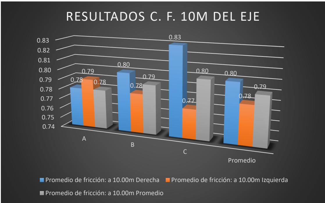
Figura 64: Coeficiente de fricción a 10.00m del eje central Fuente: Propia
