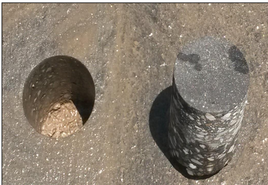
Figura 103. D-01.-Proceso de extracción de núcleo diamantina Fuente: EFE – 2015 - AdP
