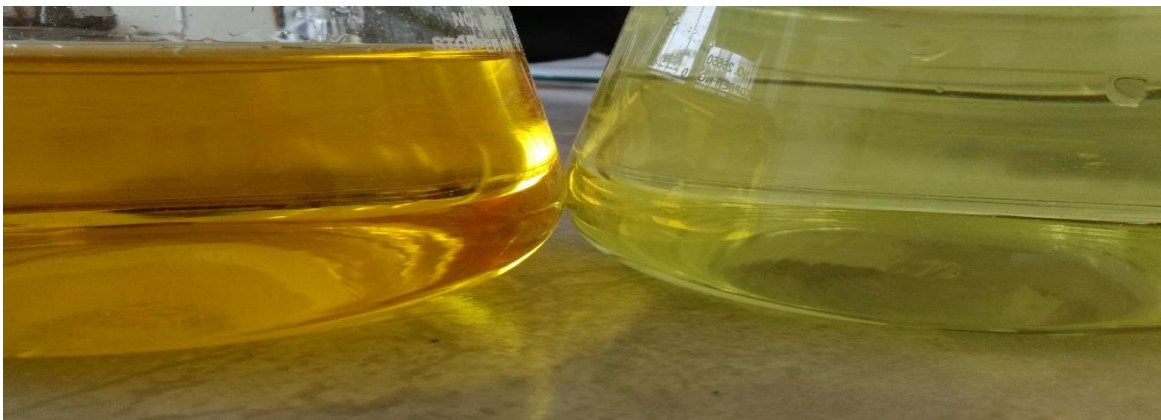
Figura N° 18. De izquierda a derecha. Solución inicial 1000 ppm Cr (VI), Filtrado final después de haber aplicado 8 g/L de adsorbente a 60 °C durante 90 min.
