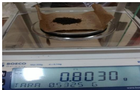
Figura N° 13. Pesado de adsorbente en Balanza Analítica
