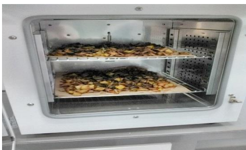
Figura N° 10. Figura N° 8. Secado en estufa a 105 °C durante 24 h.
