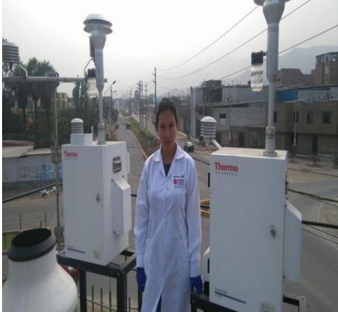
Fig. N°14: Estación Automática de Calidad del Aire del SENAMHI.
