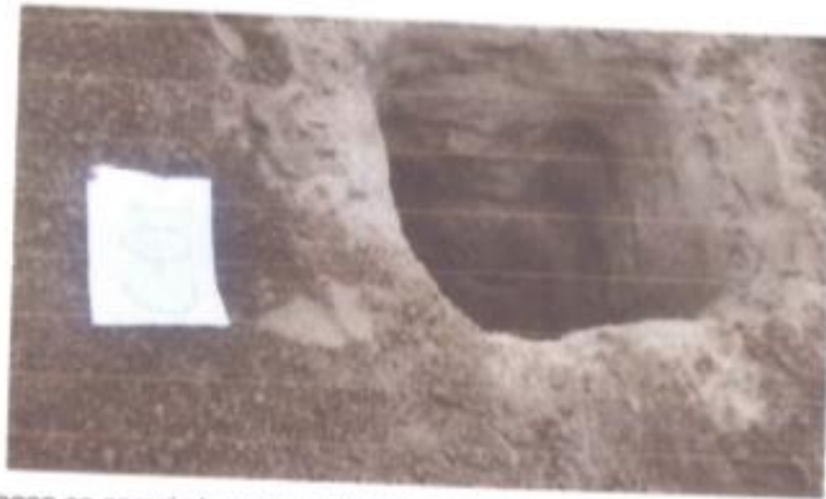
En la imagen se aprecia la realización de la calicata para la toma de muestra a una profundidad de 1.50 m
