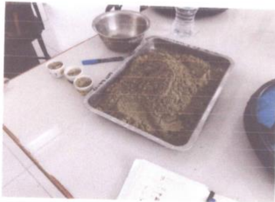
En la imagen se aprecia el pesado de la muestra para empezar con la realización del tamizado
