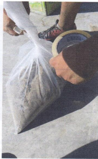
En la imagen se aprecia la toma de muestra aproximadamente 20 kg para realizar los ensayos correspondientes.
