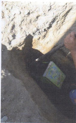
En la imagen se aprecia la toma de muestra aproximadamente 20 kg para realizar los ensayos correspondientes.
