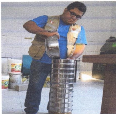
En la imagen se aprecia la realización del tamizado el cual tomara entre unos 10 a 15 minutos
