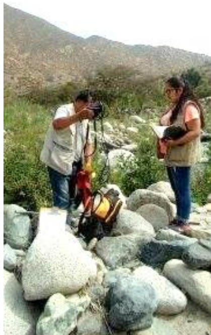
Fotografía N° 10: En el Caserío Quillhuay, para determinar el caudal de la captación, velocidad y caudal del canal, con el correntómetro.
