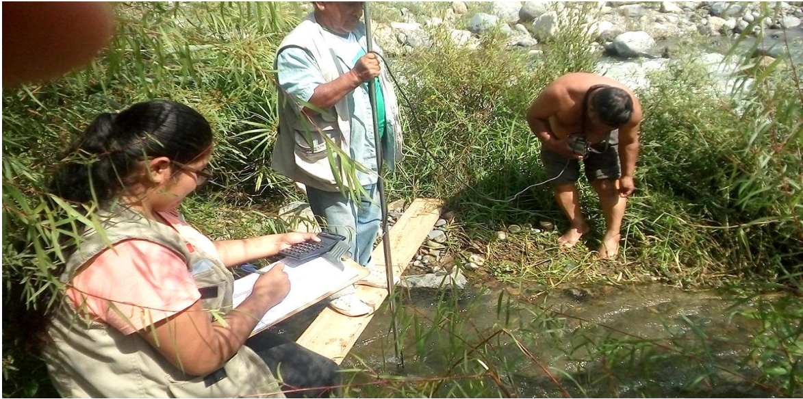
Fotografía N° 11: Se está midiendo las revoluciones cada 30 segundos en el helice
