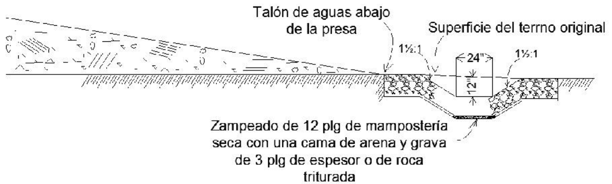
FIG. 128 Secciones típicas de la contracuneta y del dren abierto
