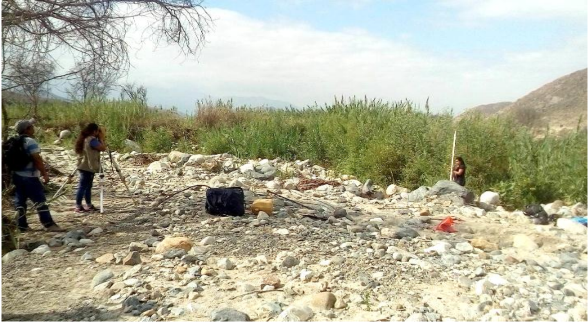
Fotografía N° 17: Realizando el levantamiento topográfico del Caserío Quillhuay.
