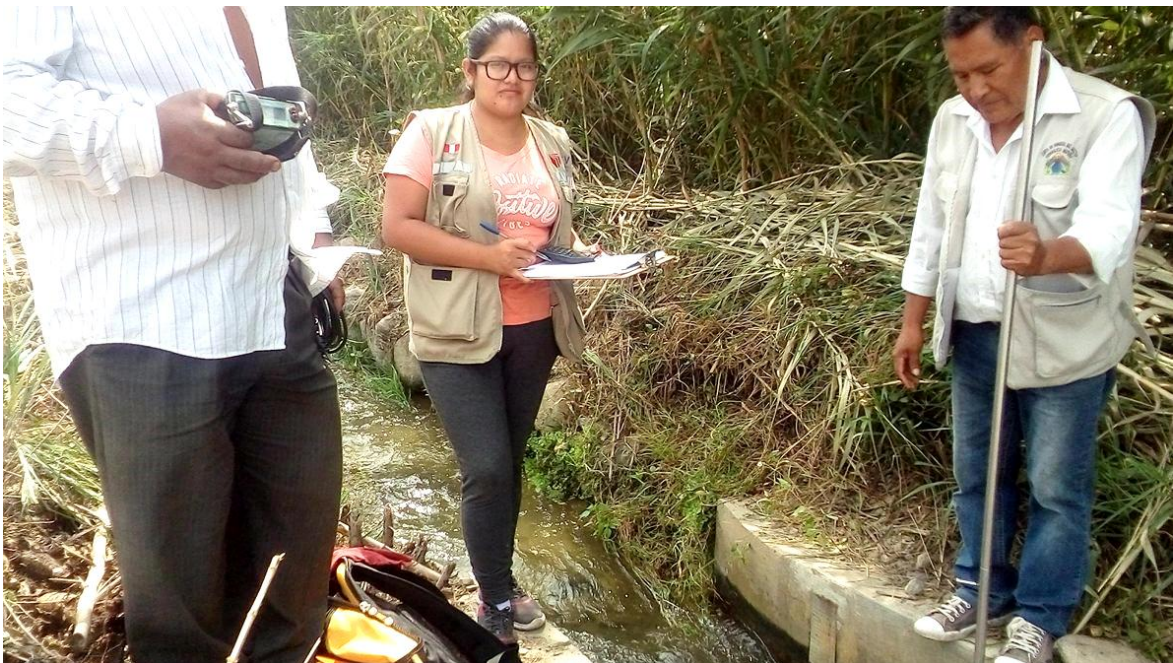
Fotografía N° 12: Usando el correntómetro para determinar el valor de la velocidad y caudal del canal.
