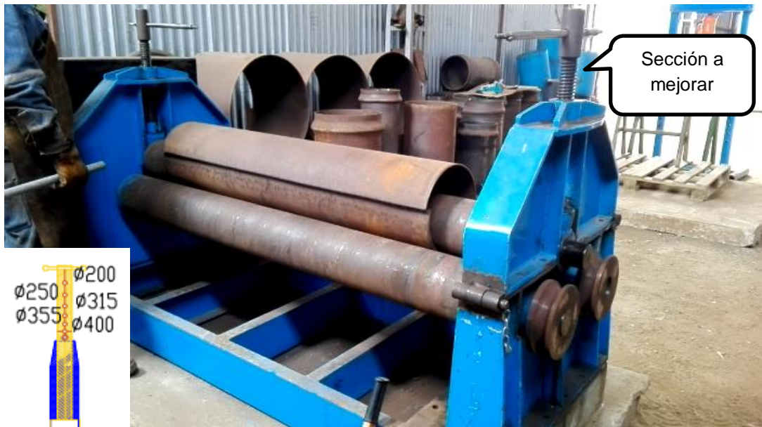
Figura 21: Máquina roladora utilizada para la formación tubular de la unión de reparación, A&N Company S.A.C, 2017. Fuente: Área de armado, A&N Company S.A.C.
