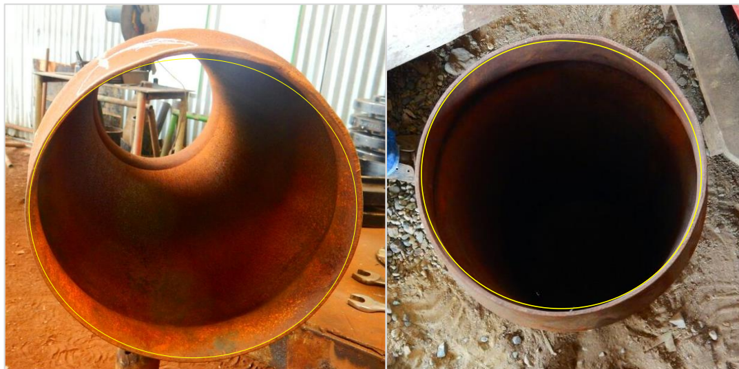
Figura 18: Mal formación de la circunferencia de la unión de reparación, A&N Company S.A.C, 2017. Fuente: Área de armado, A&N Company S.A.C.
