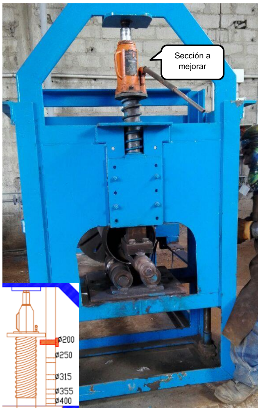
Figura 23: Máquina campanera utilizada para la fabricación de la campana de la unión de reparación, A&N Company S.A.C, 2017. Fuente: Área de armado, A&N Company S.A.C.
