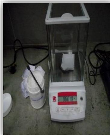
**Figura 6** Pesado del Sulfato de aluminio en las cantidades de 10, 20, 30, 40 y 50 mg.
