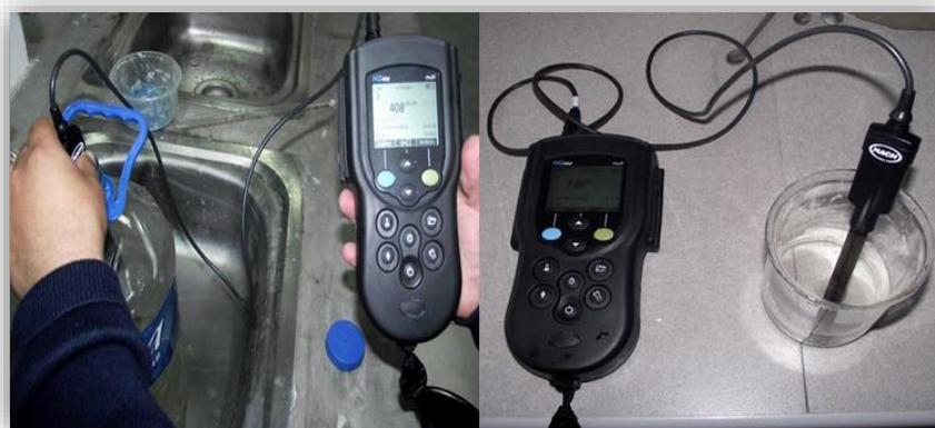
**Figura 4** Medición de Conductividad, pH y temperatura de la muestra de agua.
