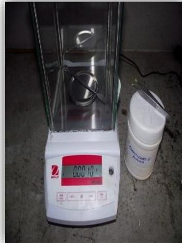
**Figura 8** Pesado del Hidroxicloruro de aluminio en las cantidades de 10, 20, 30, 40 y 50 mg
